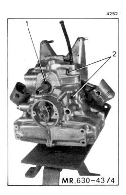
Desacoplar el motor del soporte MR. 630-43/4 y colocarlo como se indica en la figura.
