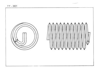
La rosca postiza HELI-COIL se presenta bajo la forma de un cable de acero inoxidable, laminado, de sección en forma de rombo y enrollada en hélice.
