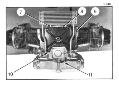
b) Motores equipados con refrigerador de aceite segundo modelo.
