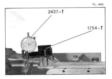
d) Sin tocar el comparador, colocar la regla 1754-T sobre la cara de apoyo del soporte sobre el cárter, la punta del comparador que descansa sobre la corona exterior del rodamiento. (Comprobar que la punta del prolongador del comparador no se apoya sobre las inscripciones grabadas en la corona de rodamiento, lo cual falsearia la lectura).
