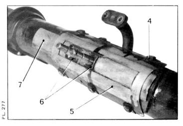
16. Colocar el casquillo de agujas o el cojinete del piñón de cremallera en la caja, utilizando un mandril doble diámetro A.
