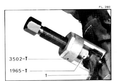
La dirección alojada en la traviesa de eje, no puede desmontarse estando colocada. Para su reparación es necesario desmontar el conjunto eje delantero-dirección. (Ver operación correspondiente).
