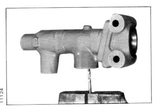
Las bombas de frenos, montadas en vehículos equipados con frenos de tambor en las cuatro ruedas, llevan una válvula de presión residual, situada en «A».
